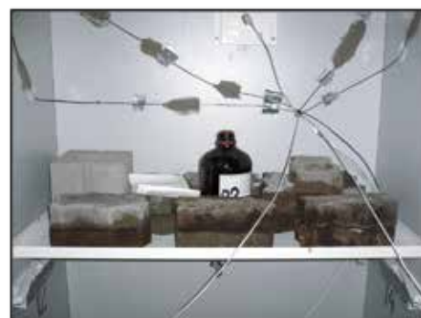
▲ Mise en place des différents capteurs
