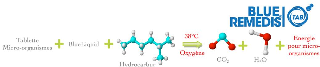
Régénération continue de la solution de dégraissage
